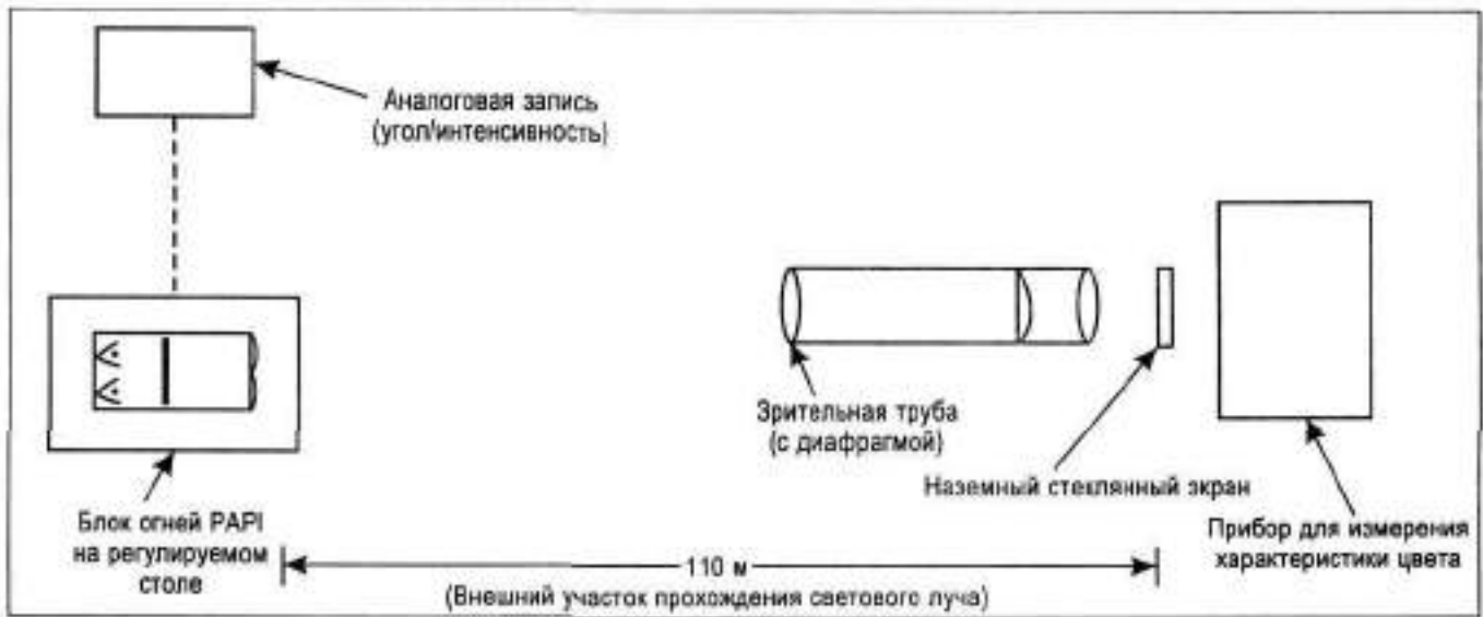
Рисунок 8-10. Схема испытательной лаборатории
